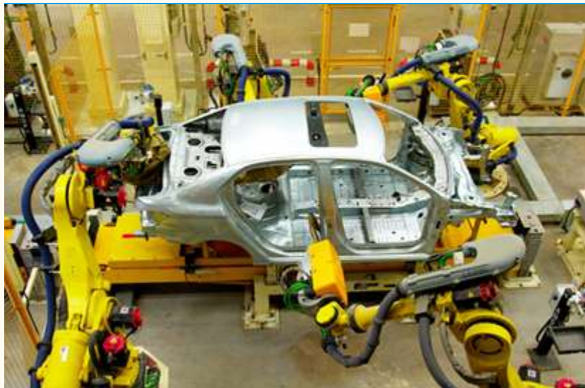
图表 15: 汽车车身普遍采用机器人焊装
